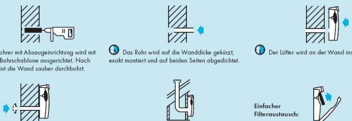
**1** Der Bohrer mit Absaugvorrichtung wird mit Hilfe einer Bohrschablone ausgerichtet. Nach kurzer Zeit ist die Wand sauber durchbohrt.
